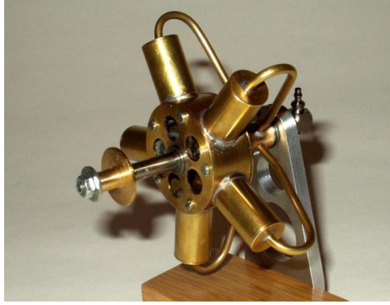
Resim 3.2: Radyal pistonlu pnömatik motor
