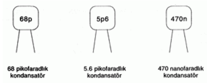
Şekil 1.20: Kondansatör değerinin okunması
