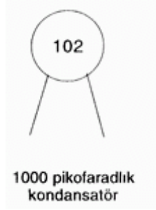
Şekil 1.21: Disk biçimindeki kondansatörün değerinin okunması
