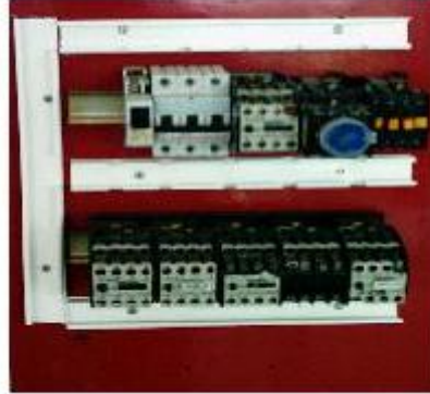
Resim 3.2: Kumanda elemanlarının yerleştirilebileceği raylı pano
