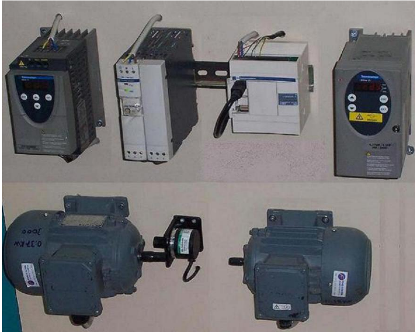
Resim 2.4: AC motor hız kontrol uygulaması
