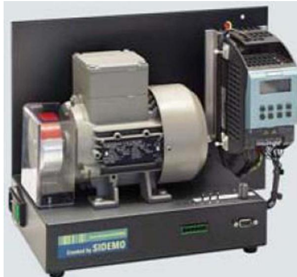
Resim 2.2: AC motor hız kontrol uygulaması
