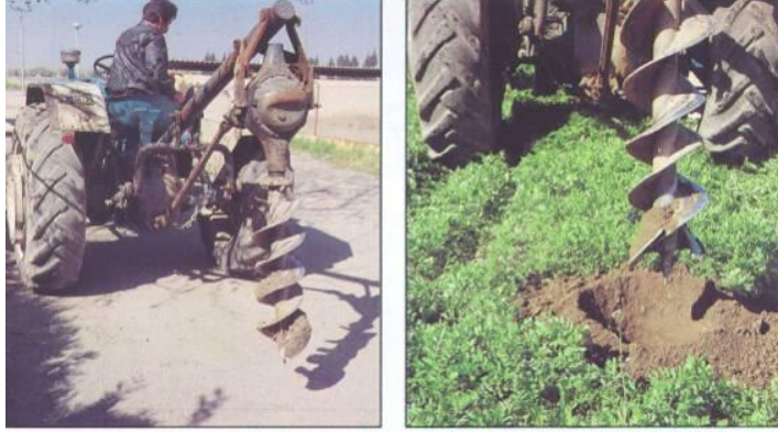
Resim 2.4:Traktör burgusu ile dikim çukurlarının açılması
