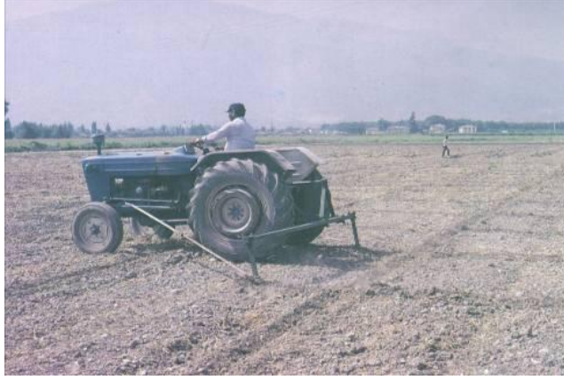
Resim 2.3. İşaretleme ekipmanı ile bağ alanının işaretlenmesi
