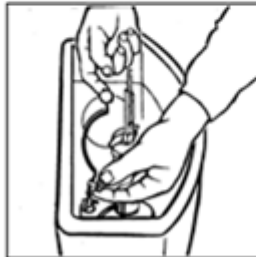
Şekil 2.11: Alafranga hela taşı (klozet) montajı
