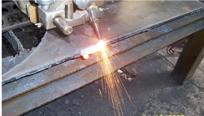
Resim 1.10: Oksijen aparatıyla kaynak ağzı açma
