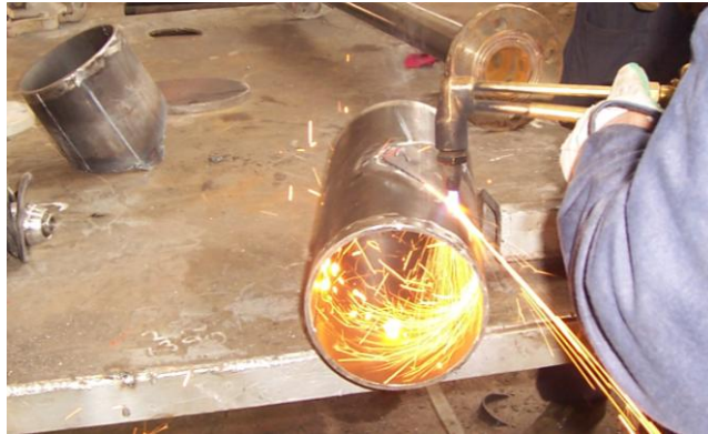
Resim 3.3: Arakesitin oksi gaz metoduyla kesilmesi
