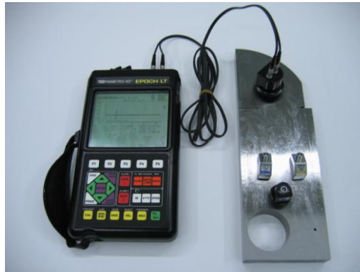
Resim 4.6: Ultrasonik muayene cihazı
