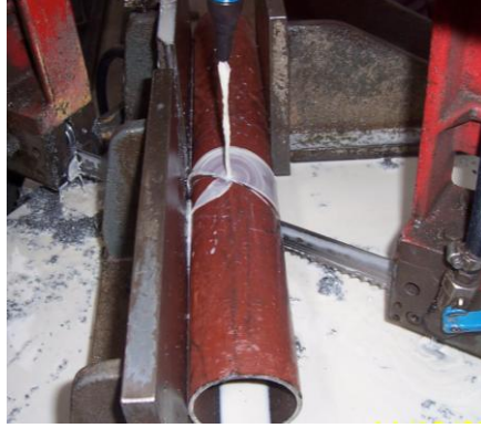
Resim 4 2: L- dirseđin řerit testere ile kesilmesi
