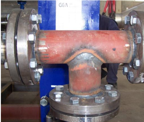
Resim 3.1: Arakesit açarak kurtağzı alıştırılmış ve parçalı dirsek yapılmış borular
