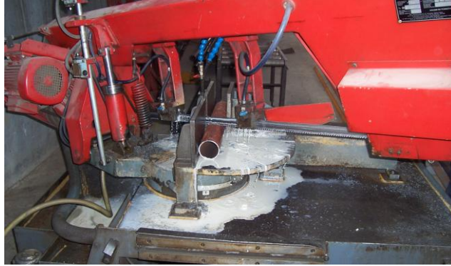
Resim 1.15: Şerit testere ile boru kesme
