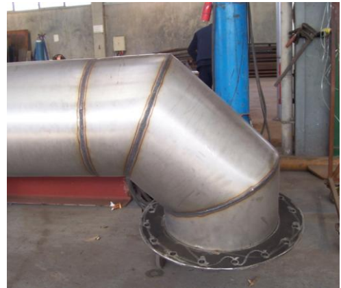
Resim 3.1: Arakesit açarak kurtağzı alıştırılmış ve parçalı dirsek yapılmış borular
