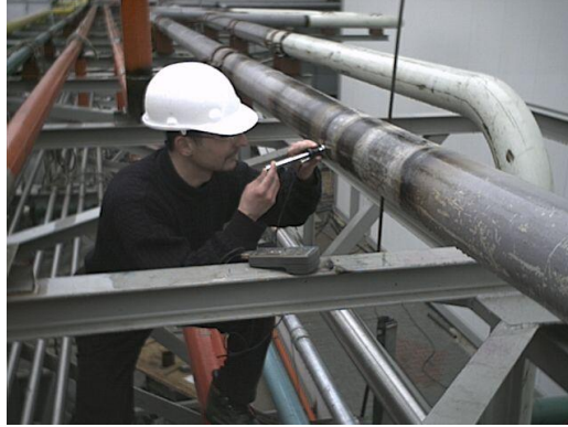
Resim 4.8: Sertlik ölçme test cihazı
