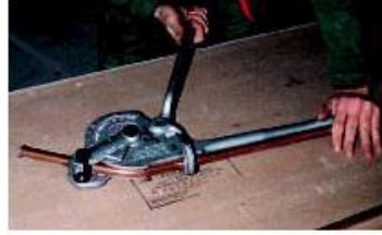
Resim 3.6: Manivela tipi aparatla bakır boru bükümü
