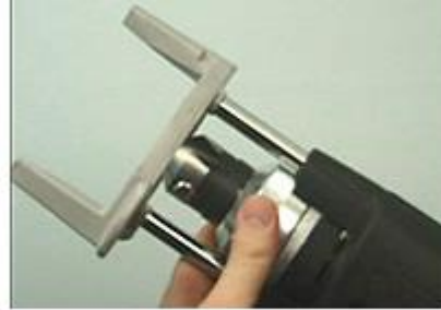
Resim 1.17: Baskı pimlerinin boru çapına göre matkap kafasına takılması
