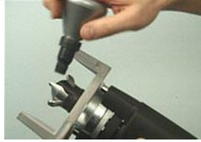
Resim 1.16: Aynalı matkap yağlama
