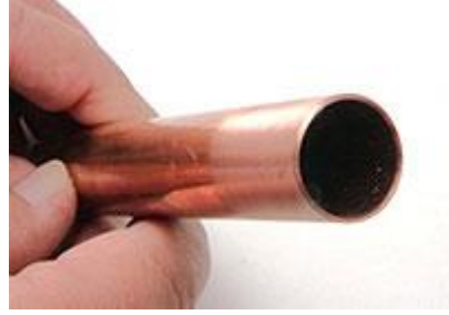
Resim 2.6: Bakır boru raybaları ve temizlenmiş boru ağzı
