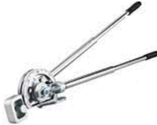
Resim 3.5: Manivela tipi bakır boru bükme aparatı
