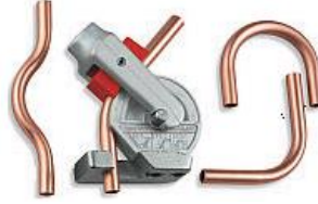
Resim 3.7: Manivela ile bükülmüş bakır borulara örnekler
