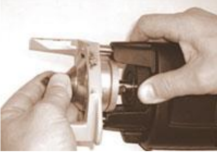
Resim 1.15: Aynalı matkap kafa montajı
