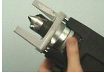
Resim 1.15: Aynalı matkap kafa montajı
