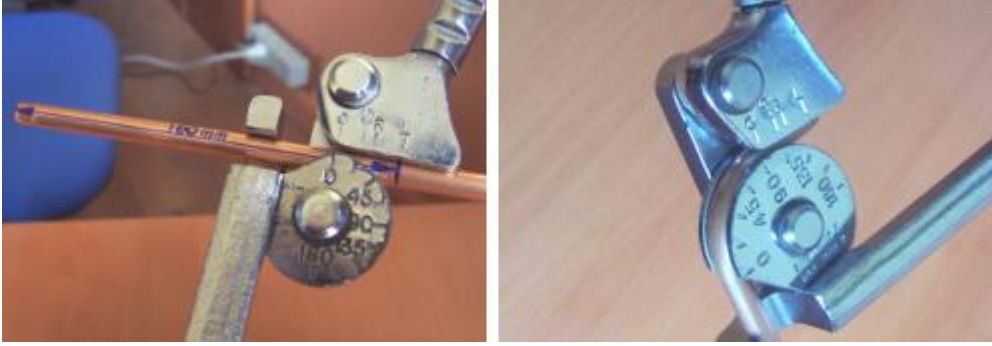
Resim 5.7: İş parçasının bükme aparatına yerleştirilmesi ve bükülmesi
