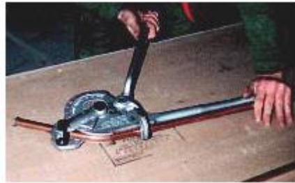
Resim 5.3: Manivela tipi aletle bakır boru bükümü
