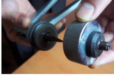
Resim 3.9: Muf açma aparatı
