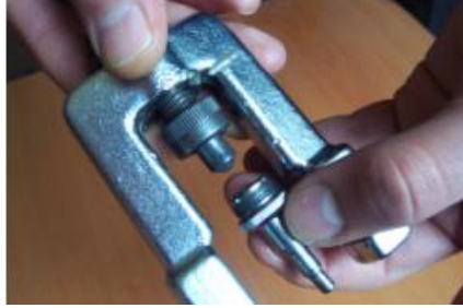
Resim 3.8: Zımbanın havşa aparatına takılması
