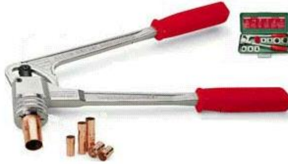
Resim 3.2: Muf açma aparatı ve muf açılmış borular
