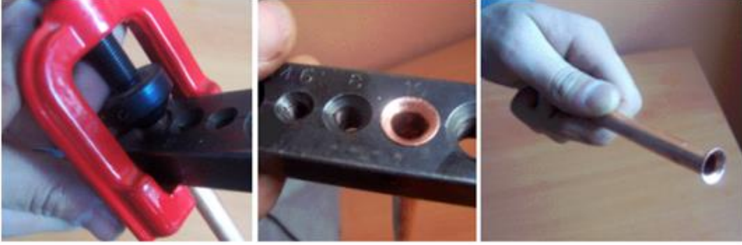
Resim 4.4: Havşa takımı kullanarak havşa açma
