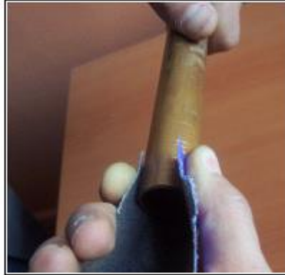
Resim 2.6 : Zımpara ile boru yüzeyindeki çapak ve oksit tabakalarının temizlenmesi
