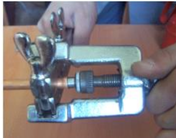
Resim 3.10: Havşa aparatı ile muf açma
