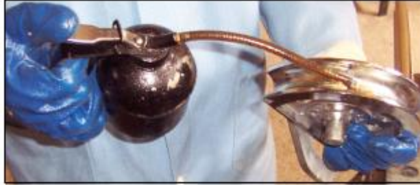
Resim 5.6 : Bükme aparatının tekerlek kanallarının yağlanması
