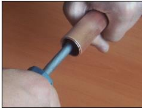
Resim 2.3 : Yuvarlak eğe ile çapak alma
