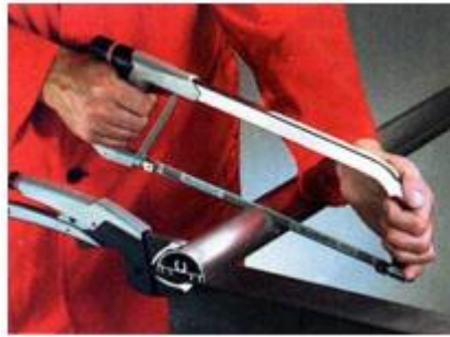
Resim 1.11: El testeresi ile bakır boru kesme işlemi
