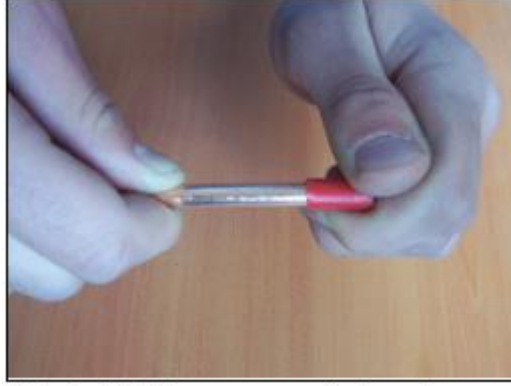
Resim 2.7 : Borunun tapa ile kapatılması
