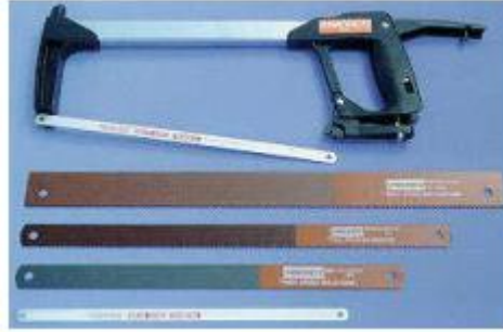
Resim 1.10: İnce dişli el testeresi ve çeşitli lamalardan örnekler
