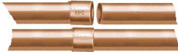
Resim 1.1: Muf açılmış boru ve birleştirilmiş borular
