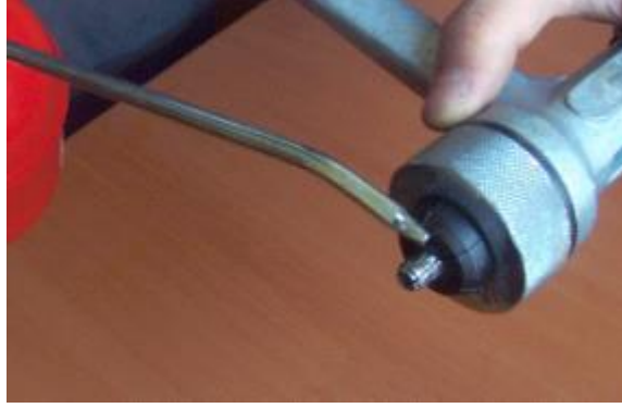
Resim 3.5: Muf açma aparatının yağlanması
