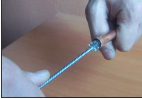
Resim 2.4 : Tel fırça ile boru temizliği
