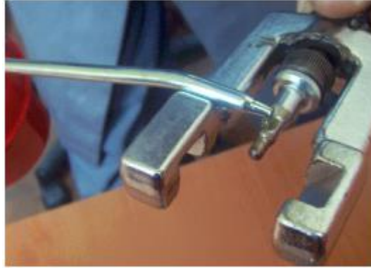
Resim 3.4: Havşa takımında zımbanın yağlanması
