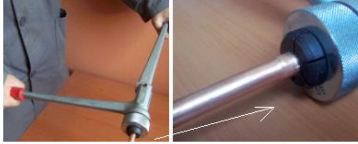
Resim 3.11: Muf açma aparatına borunun yerleştirilmesi
