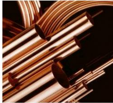
Resim 1.4: Yumuşak ve sert çekilmiş bakır borulara örnekler
