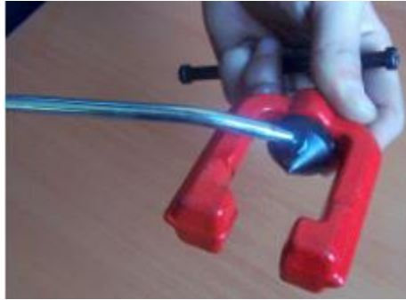
Resim 4.3: Havşa konisinin yağlanması
