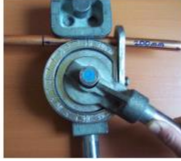
Resim 5.10: Büyük çaplı bakır boruyu bükme aparatında bükme
