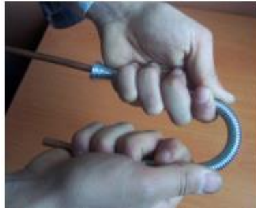
Resim 5.9: Bakır borunun bükme yayısı ile bükülmesi
