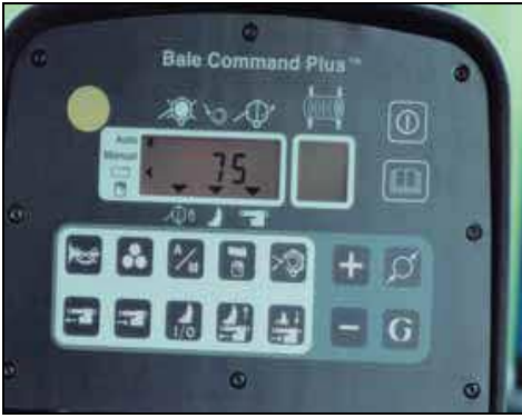
Resim 2.2: Rulo balya makinelerinde kullanılan monitör
