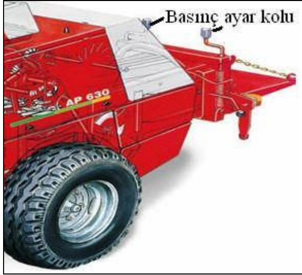
Resim 1.7: Köşeli balya makineleri balya sıklığı ayar kolları
