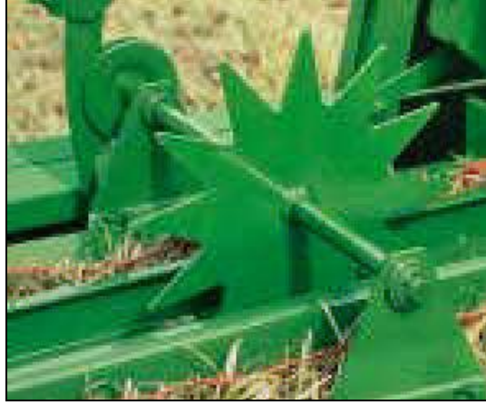
Resim 1.6: Köşeli balya makinesi balya boyu ayarlayıcısı
