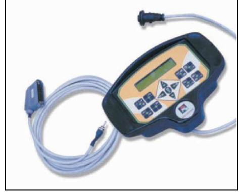
Resim 2.2: Rulo balya makinelerinde kullanılan monitör
