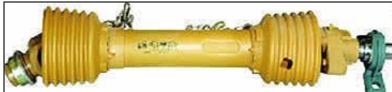
Resim 1.11: Köşeli balya makinelerinde kullanılan mafsallı şaft, muhafazası ve tespit zinciri
