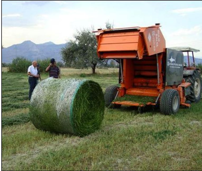
Resim 2.3: Rulo balya makinelerinde yapılan balyanın dışarı bırakılması
