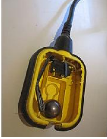
Resim 1.5: Flatör içindeki metal top ve mikro anahtarın (Butonun) konumu
