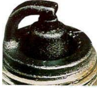
Şekil 3.15: Aşırı yağlanmış buji
