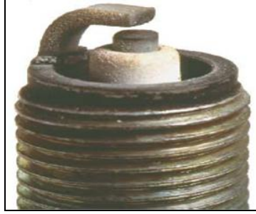
Şekil 3.13: Çalışan bujide normal görünüm
