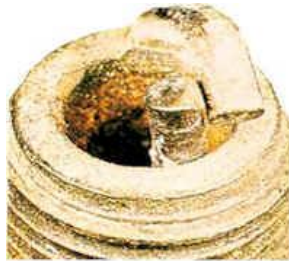
Şekil 3.14: Mekanik hasarlı buji
