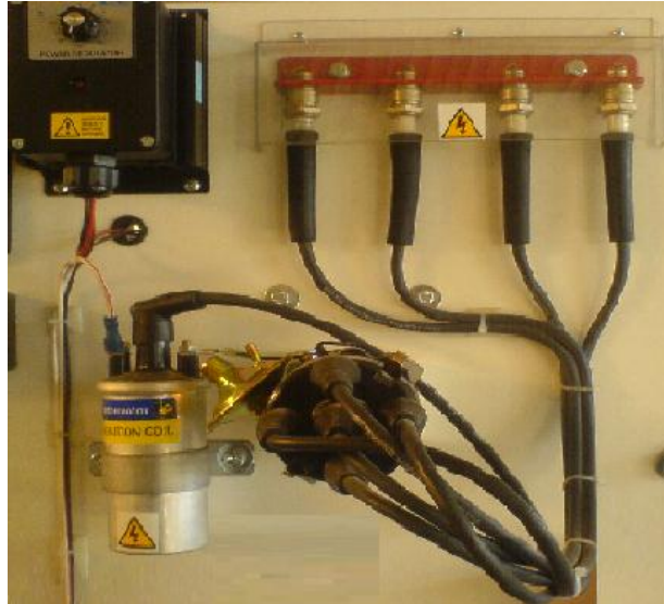
Resim 1.1: Klasik ateşleme sistemi
