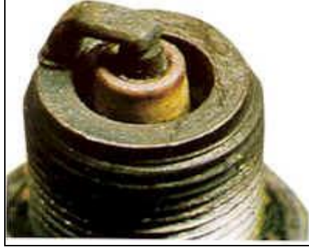
Şekil 3.18: İletkeni Donuklaşmış buji
