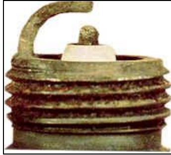
Şekil 3.16: Aşırı ısınmış buji
