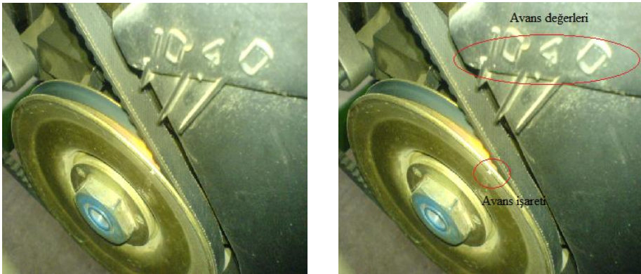
Resim 5.2: Krank kasnağı veya volan üzerindeki başlangıç avans işareti
