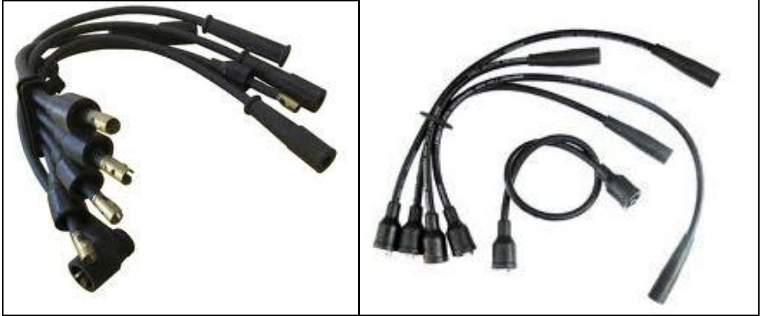
Resim 4.1: Yüksek gerilim kabloları
