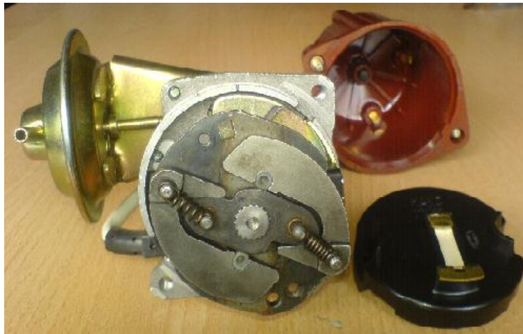
Resim 1.5: Sökülmüş distribütörde mekanik avans tertibatı resmi
