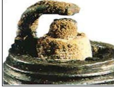
Şekil 3.17: Kurum bağlamış buji
