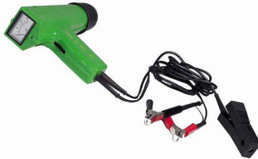
Resim 5.1: Avans tabancası (neon lambası)
