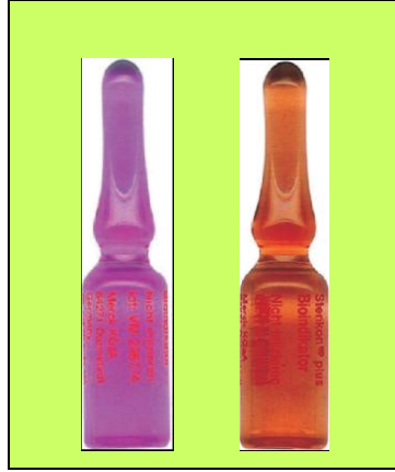
Resim 2. 4: Sterikon biyoindikatör, sarı turuncu renk yetersiz sterilizasyonu gösterir.
