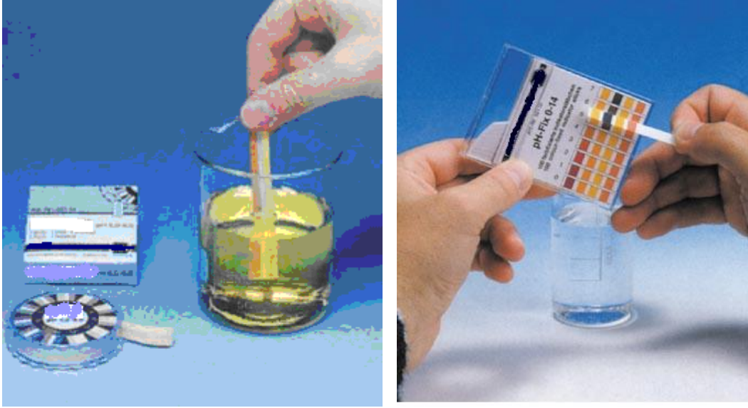
Resim 1.2: Besiyeri pH'sının pH kâğıtları ile ölçülmesi
