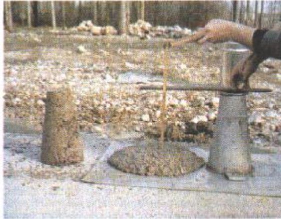
Resim 18: Çökme (Slump) Deneyi Uygulaması
