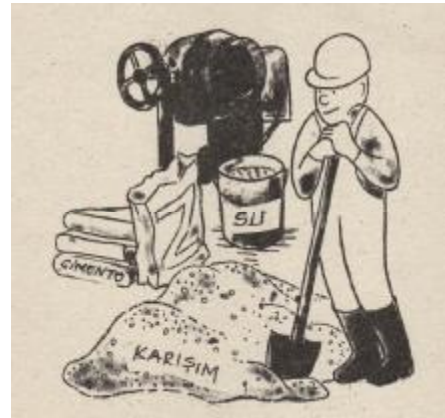
Resim 20- Beton Harcının Betoniyerle Karıştırılması
