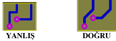
Şekil 4.16: Köşeli bağlantı yolları
