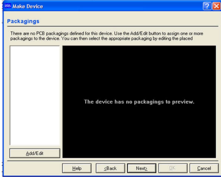
Şekil 5.30: Elemanın PCB tanımlama penceresi
