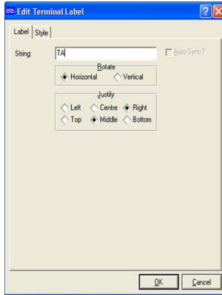
Şekil 4.14: Terminal uçlarının isimlendirilmesi
