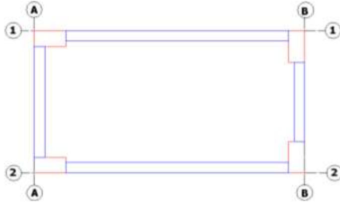
Şekil 1.10: Kolonlar arasında duvarların çizilmesi
