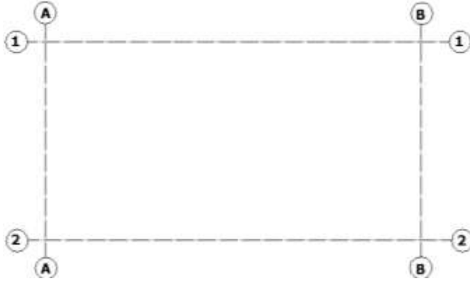
Şekil 1.8: Kolon akslarının çizilmesi
