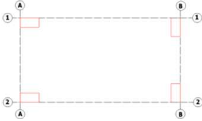
Şekil 1.9: Akslara kolonların yerleştirilmesi
