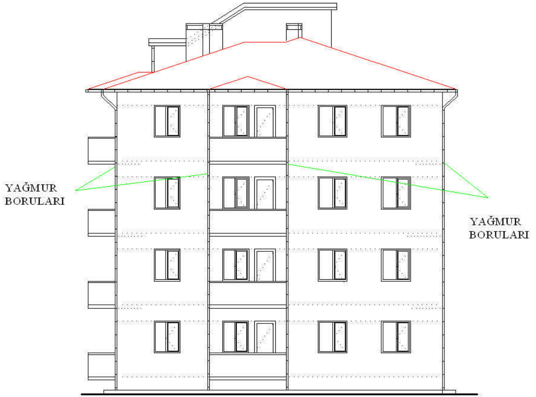
Şekil 2.14: Yağmur iniş boruları
