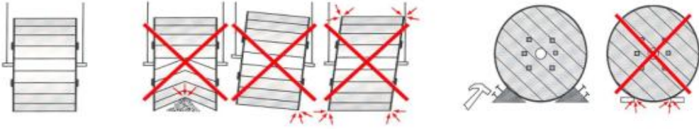
Şekil 2.9: Kablo makarasının döşenme yerine getirilmesi
