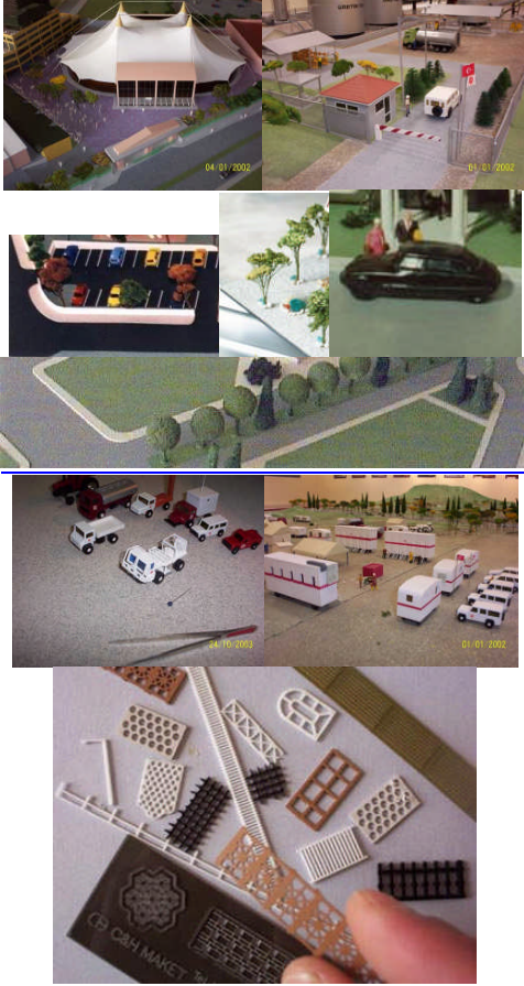
Resim 1.43: Bina maketi yapımında kullanılan çeşitli kaplamalar, insanlar, bitkiler, arabalar, yapı elemanları, hazır desenler, vb. malzemelerden bazıları
