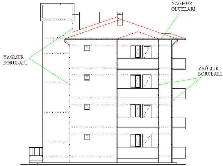
Şekil 1.17: Yağmur borularının çizilmesi
