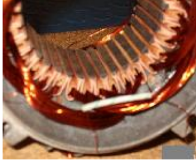
Resim 1.21: Ekler ve ek yalıtımları
