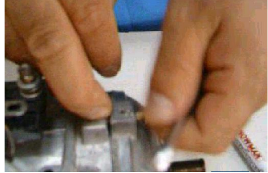
Resim 1.8: Kapak vidalarının sökülmesi
