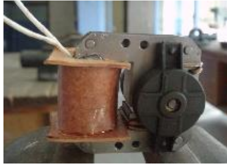
Resim 2.15: Montajı tamamlanan motor
