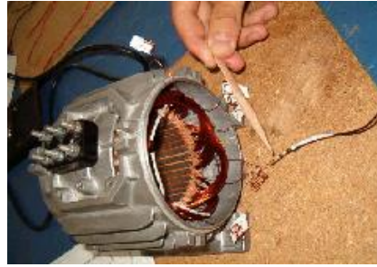
Resim 1.22: Bobin uçlarının klemens tablosuna çıkarılması
