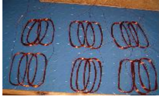
Resim 1.19: Ana ve yardımcı sargıların ayrılması
