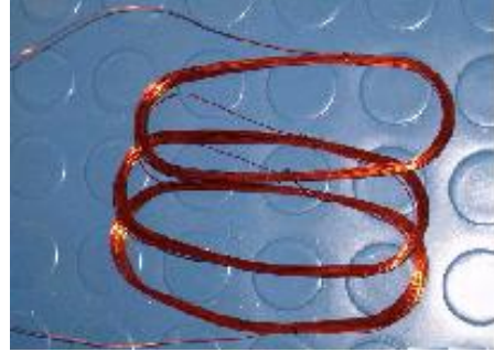
Resim 1.16: Sarılmış bobin grubu
