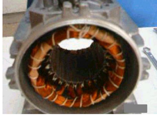
Resim 1.12: Statorda sökölmeye hazır sargılar
