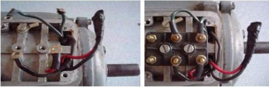
Resim 1.27: Klemens tablosu bağlantısı
