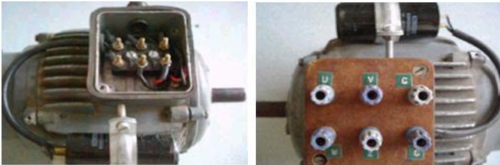
Resim 1.28: Sarımı ve montajı bitirilmiş motor
