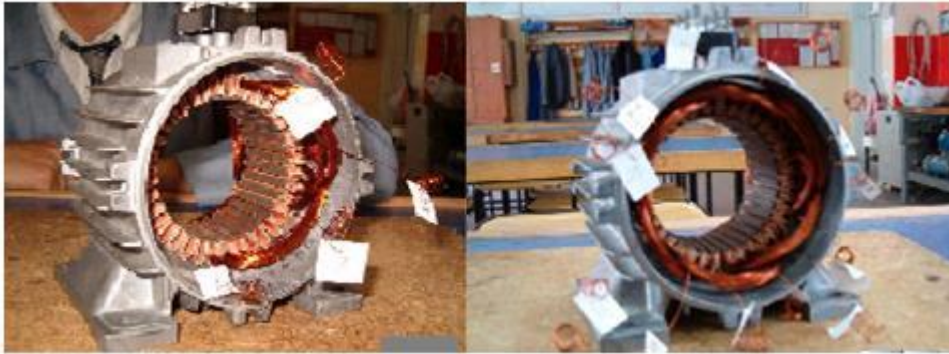
Resim 1.20: Bobinlerin statora yerleştirilmesi ve uçlarının etiketlenmesi
