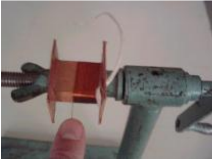
Resim 2.11: Makaraya bobinin sarılması
