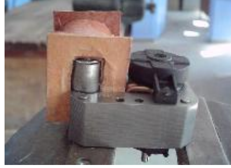
Resim 2.14: Bobinin statora yerleştirilmesi
