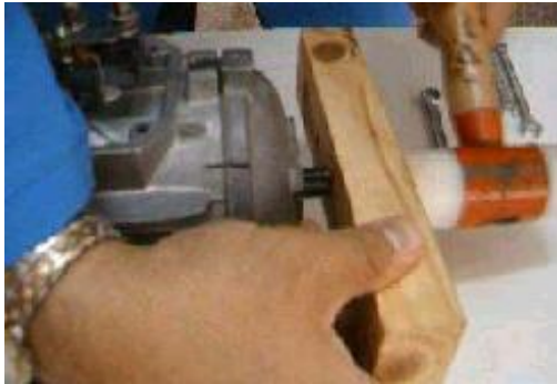
Resim 1.9: Rotoru takozla vurulması
