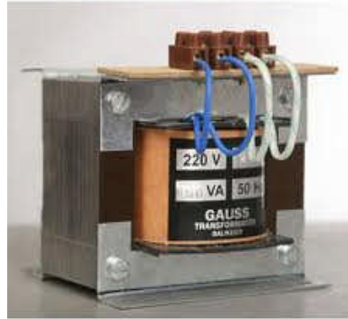
Resim 3.7: Transformatorün koşebent ve klemens montaj yapılmış hâli
