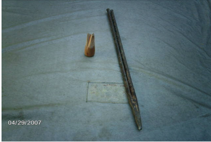
Resim 1.7 a: Çubuk yarma tahtası ve kabuk soyma aracı
