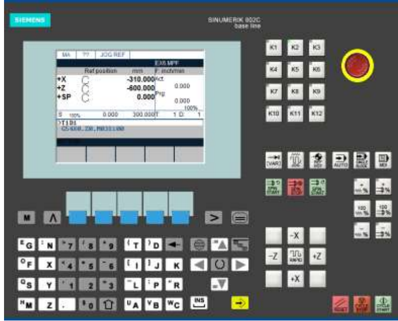
Resim 1.4: Siemens kontrol paneli
