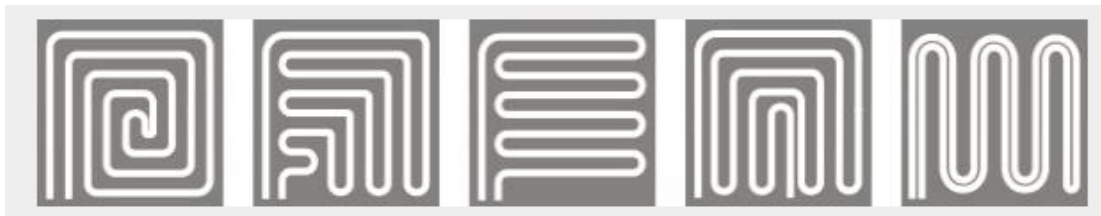
Şekil 3.5: Yerden ısıtma boru döşeme desenleri
