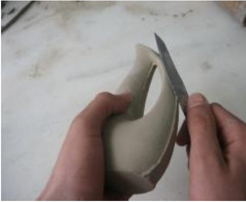
Resim 3.1: Kalıp izlerini bıçakla düzeltme
