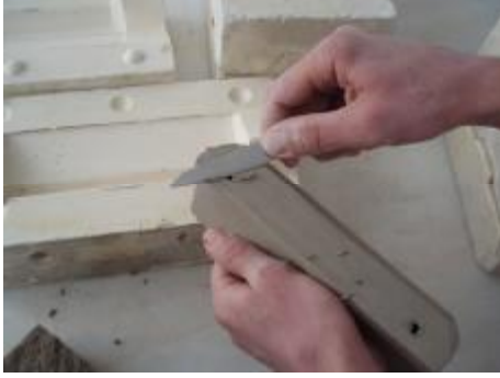
Resim 3.3: Döküm ağızını rötuşlama
