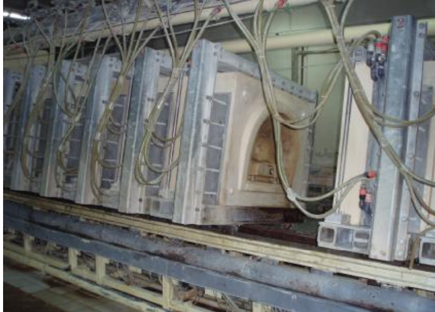
Resim 2.3: Yüksek basınçlı döküm
