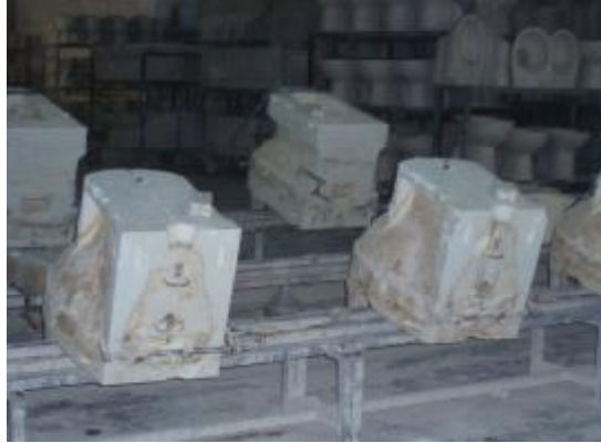
Resim 2.12: Çamurun kalınlık alması için bekleme
