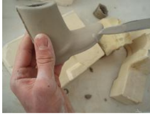
Resim 3.5: Döküm aşamasında oluşan hataları giderme
