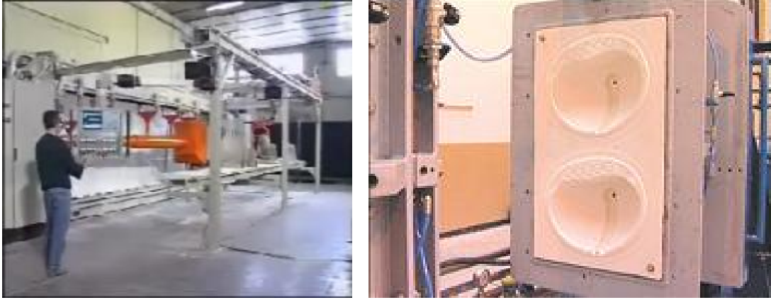
Resim 2.9: Yüksek basınçlı döküm yöntemi ile lavabo şekillendirme
