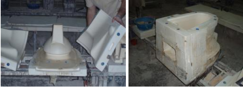
Resim 2.1.4: Kalıbın yan parçalarını kapatma
