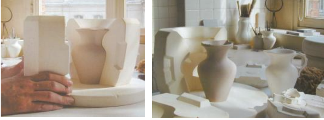
Resim 2.10 : Boş döküm yöntemi ile vazo modelinin kalıpta yapılışı
