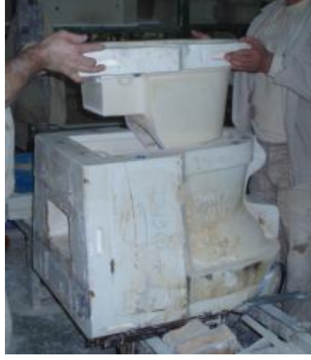
Resim 2.1.5: Kalıp parçalarını kapatarak döküme hazırlama
