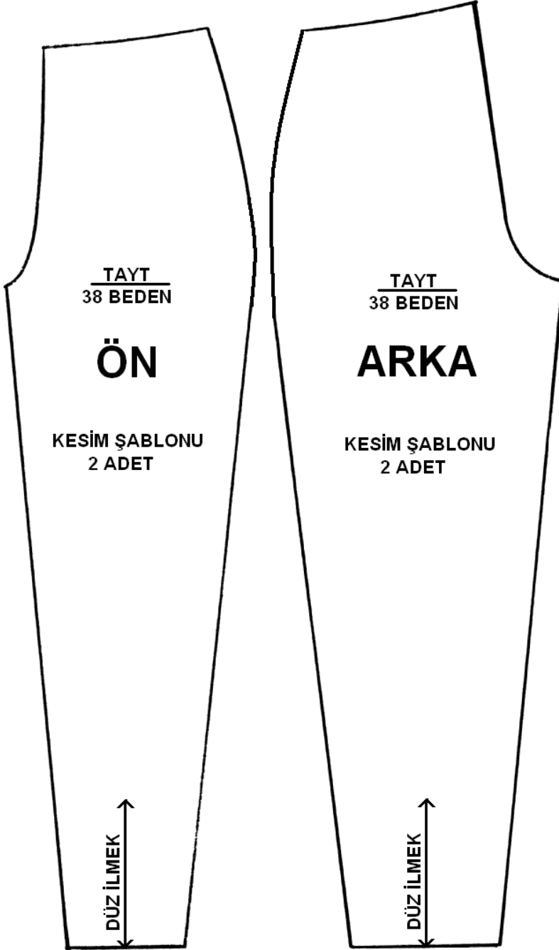
Şekil 3.4: Tayt kesim şablonu
