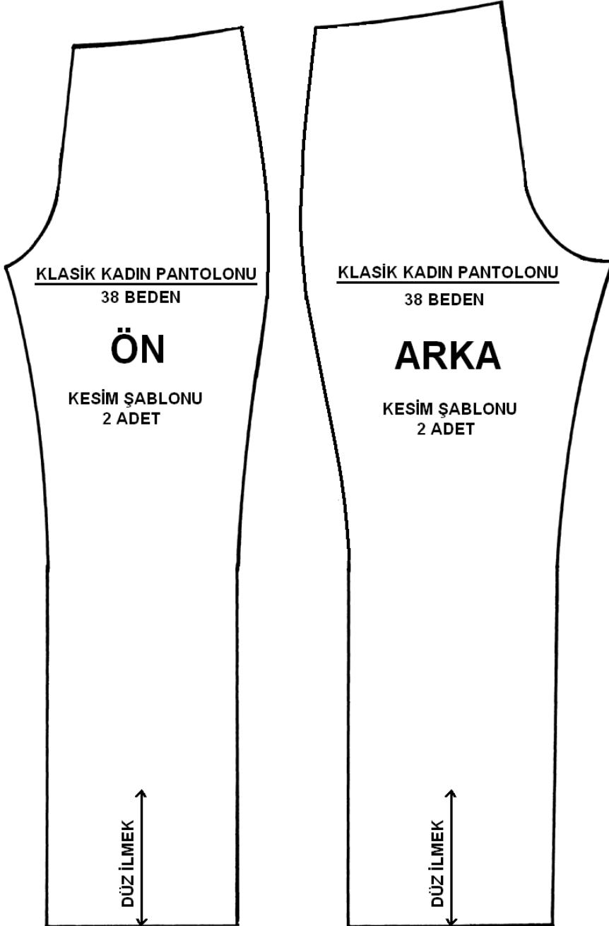
Şekil 1.4: Klasik kadın pantolon ön ve arka beden kesim şablonu
