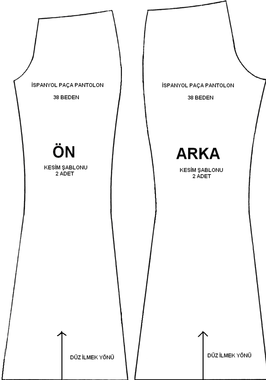
Şekil 2.4: İspanyol paça pantolon ön ve arka beden kesim şablonu
