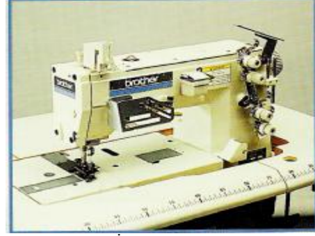
Şekil 6.7. Çift İplik Zincir Dikiş Makinesi
