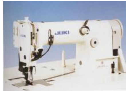
Şekil 5.6. Tek İplik Zincir Dikiş Makinesi
