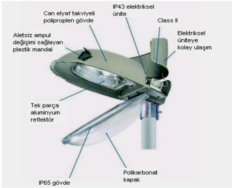
Resim 1.2: Dış aydınlatma armatürünün yapısı
