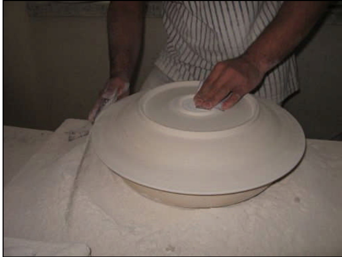
Resim 1.2: 20-30 cm’lik tabağın bomse üzerine yerleştirilmesi
