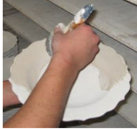
Resim 2.6: Tabağın ön yüzeyinin astarlanması
