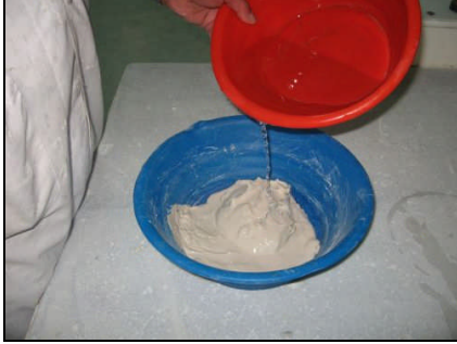
Resim 2.1: Astarın sulandırılması Resim 2.2: Astarın karıştırılarak hazırlanması
