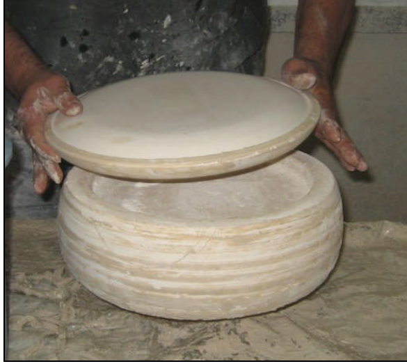
Resim 1.1: Rötüş bomsesinin kalıp başlığına yerleştirilmesi
