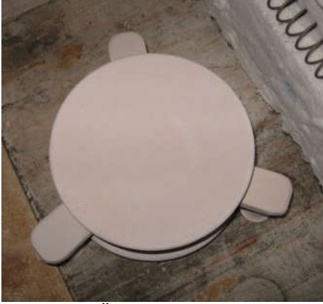
Resim 2.10: Üçgen ayağa tabağı yerleştirilme sıralaması
