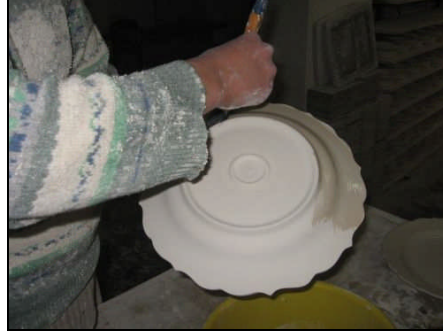
Resim 2.4: Tabağın alt yüzeyinin astarlanması.
