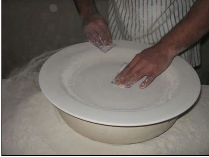
Resim 1.6: 20-30 cm'lik tabađın ön yüzeyinin zımparalanması
