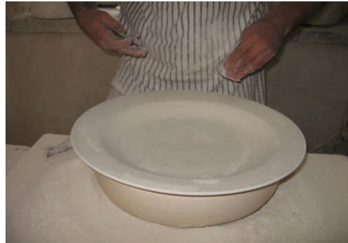
Resim 1.5: Tabağın ayağının kalıba oturması
