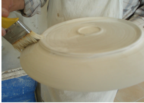
Resim 2. 3:Tabağın ve fırçanın tutuluşu
