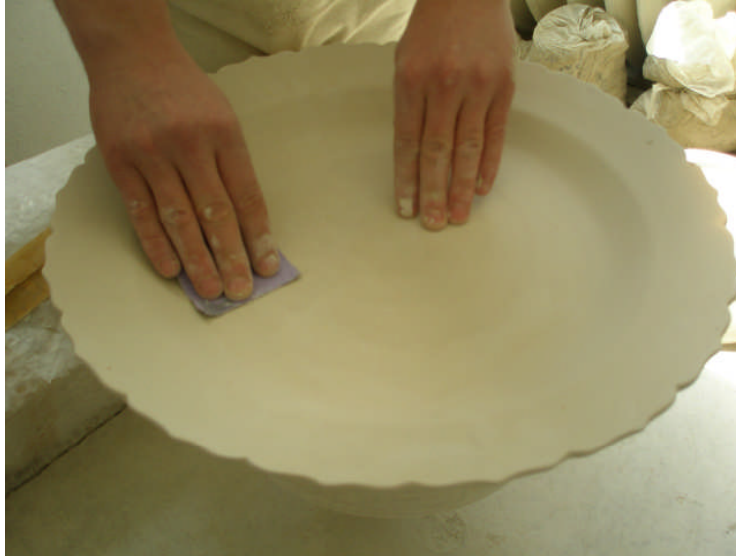
Resim 1.5: 20-30 cm'lik tabađın 6n y6zeyinin zımparalanması
