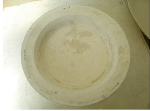
Resim 1.4: Tabađın ayađının kalıba oturması
