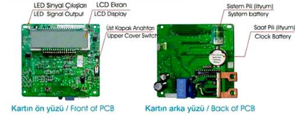
Resim 1.25: Elektronik sayaç iç yapısı
