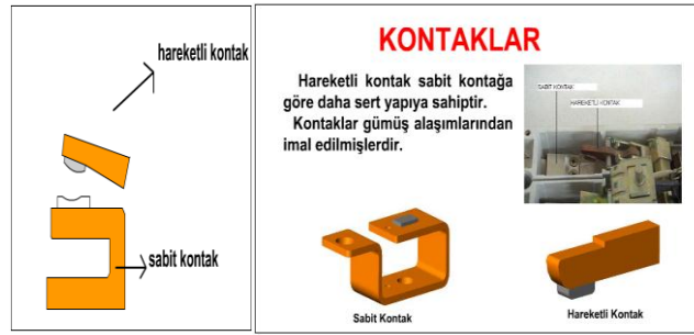
Şekil 1.6: Termik manyetik şalter kontakları
