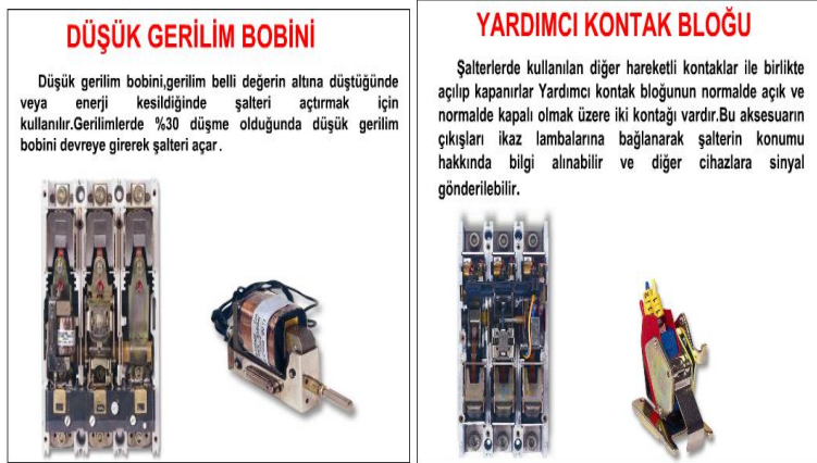
Resim 1.18: Kesici ilave düşük gerilim bobini ve yardımcı kontak bloku
