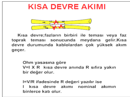
Şekil 1.10: Kısa devre akımı oluşumu
