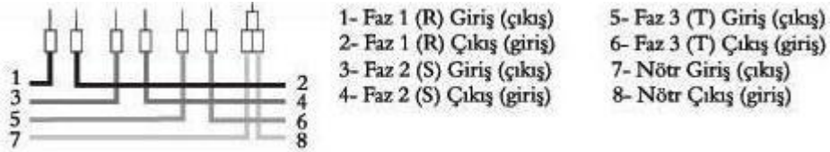
Şekil 2.4: Üç fazlı sayacın bağlantısı
