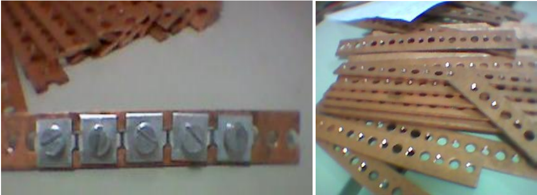
Resim 2.15: Tabloda bulunan bakır barası
