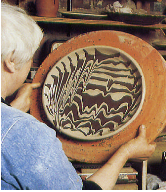
Resim 5.3: Ebru tekniği ile astarlama
