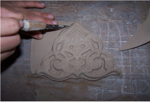
Resim 3.9 :Levhanın fazlalıklarını kesme Resim3.10: dekorun arka yüzeyini çentikleme
