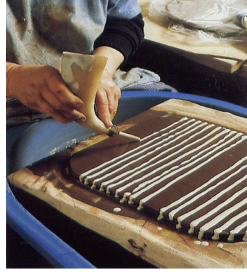
Resim 5.4:Plakayı ebru tekniği ile astarlama
