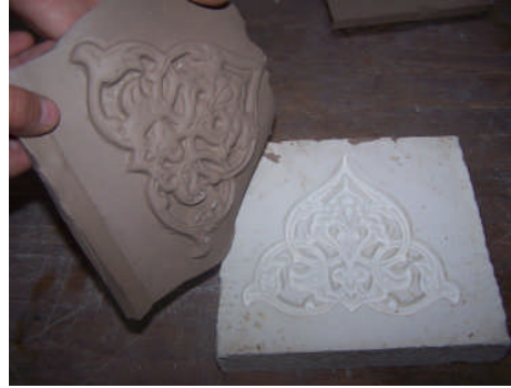
Resim 3.8:Levhayı kalıptan çıkarma
