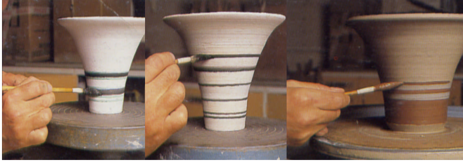
Resim 5. 7:Fırça ile astar akıtma
