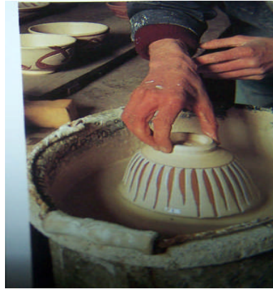
Resim 5.6:Muylama tekniğini astarla uygulama
