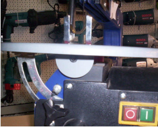
Resim 2.9: Tabla derecesi ve tespit vidası
