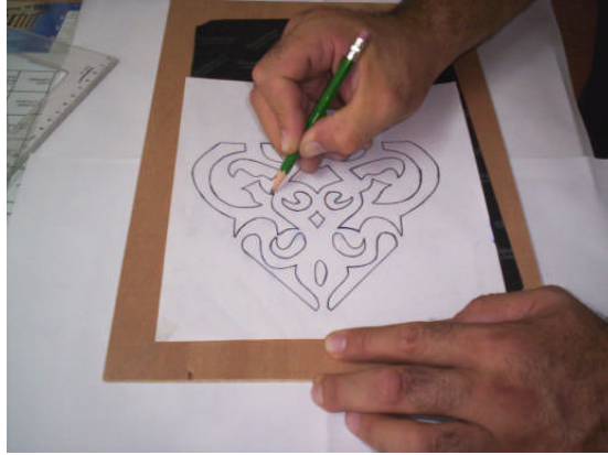
Resim 1. 8: Dekupe oyma için yüze motif çizme
