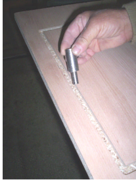
Resim 2.2: Oyma kalıp şekillendirme ve kalıba uygun kılavuz pimi
