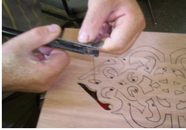
Resim 1. 9: Kıl testerenin iş parçasından geçirilip sıkılması
