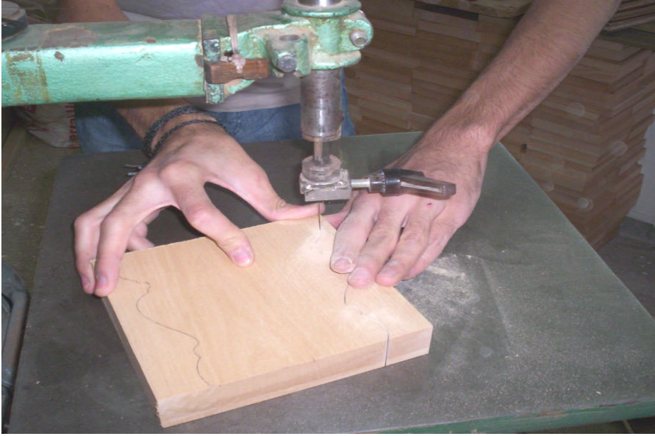
Resim 2.15: Masif parça kesimi
