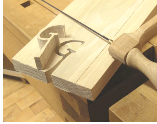
Resim 1. 14: Dekupe oyma harf kesimi
