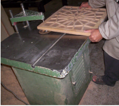
Resim 2. 26: İş parçasının yerleştirilmesi
