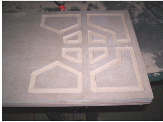
Resim 2. 29: Kalıp hazırlama kalıp ile iŐ parŐasının iŐlenmesi
