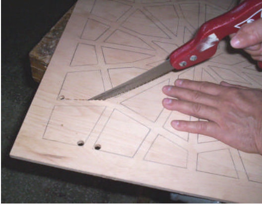
Resim 2. 5: Farekuyruğu testere ve kıl testere ile şekillendirme
