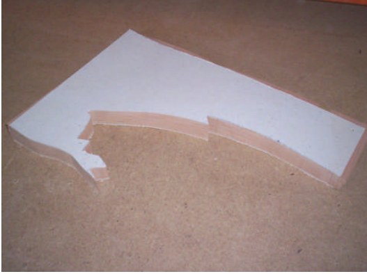
Resim 2.11: Kaplama kenar kesimi
