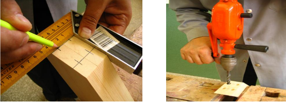
Şekil 1.45: Delik merkezlerini markalama ve delik delme
