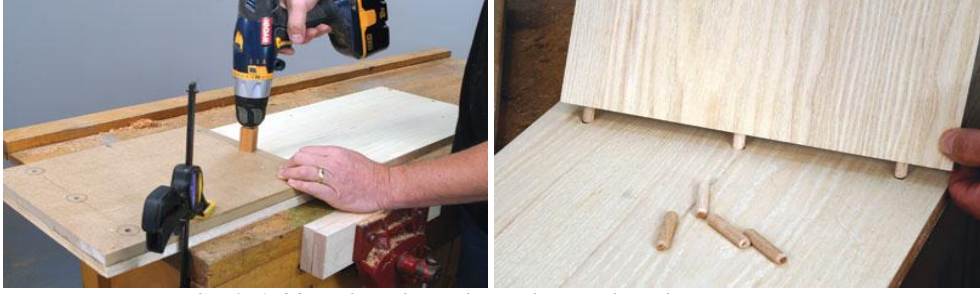
Şekil 1.44 Deliklerin delinmesi ve deliklerin kontrolü
