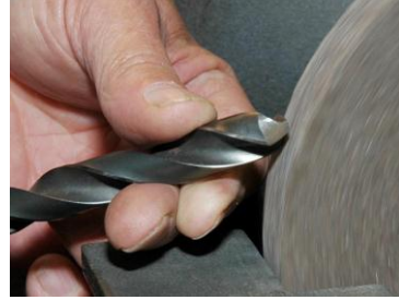
Resim 1.20: Helisel matkabin bilenmesi
