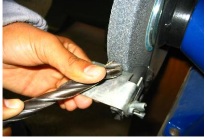
Resim 1.20: Helisel matkabin bilenmesi
