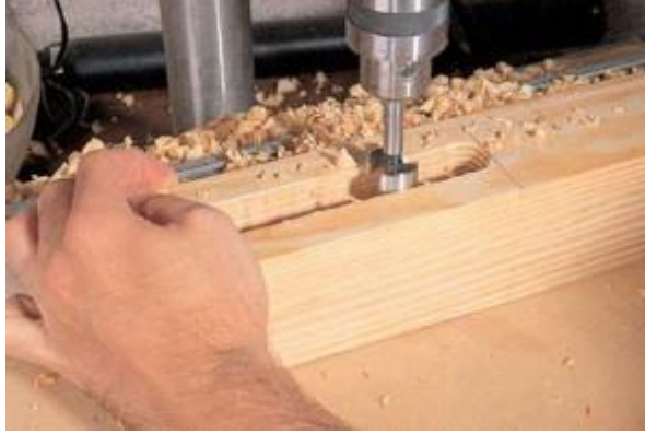
Resim 2.21: Tabla kenarlarına delik delme uygulamaları
