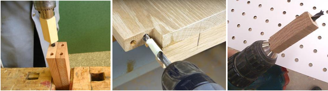
Resim 1.31: Stop takozu ve kâğıt bant ile delik derinliği ayarlama
