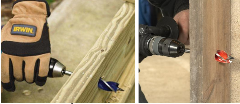
Resim 1.9: İrvin matkabı ile delik delme uygulaması
