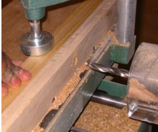
Resim 2.22: Tabla kenarlarına delik delme uygulamaları
