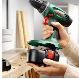
Resim 1.23: Akünün takılması ve örnek delik uygulaması
