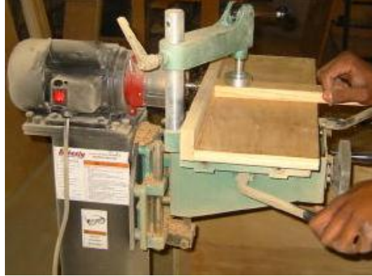
Resim 2.21: Tabla kenarlarına delik delme uygulamaları
