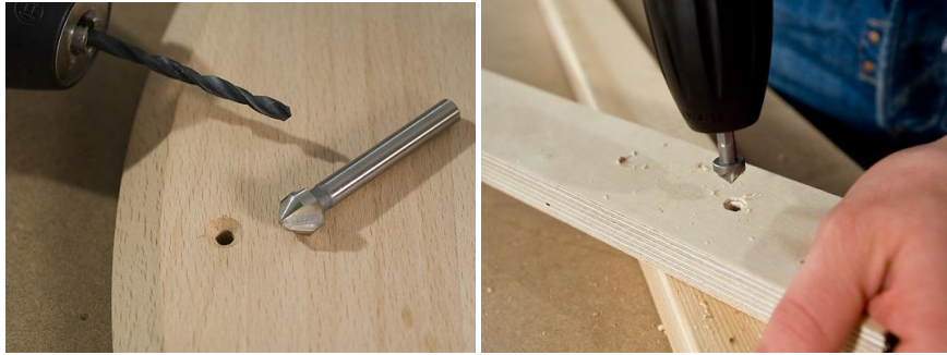
Şekil 1.42: Delik delme ve havşa açma uygulaması
