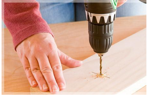
Resim 1.23: Akünün takılması ve örnek delik uygulaması
