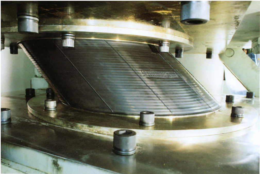
Resim 2. 4: Bir kauçuk izolatör laboratuvar ortamında yük deneyinde
