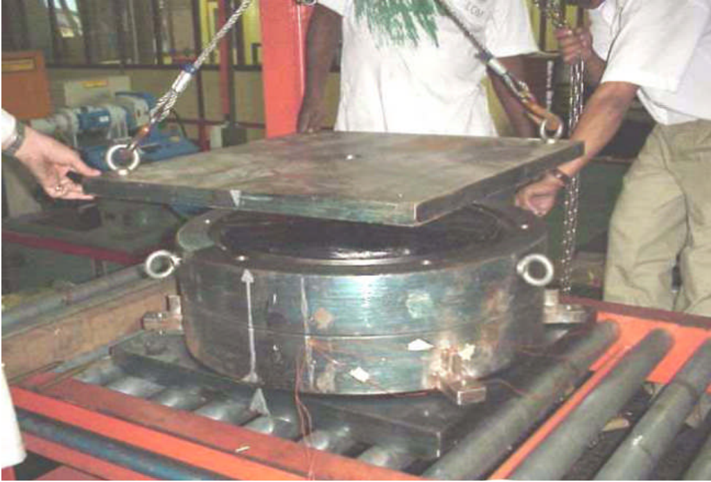
Resim 2. 3: Kauçuk esaslı izolatörün kalıba dökülmesi
