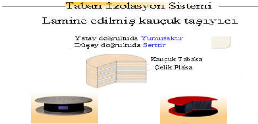
Şekil 2. 3: Lamine edilmiş kauçuk taşıyıcı
