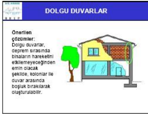
Şekil 1.4: Dolgu duvar uygulaması
