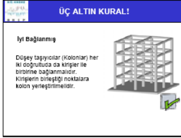
Şekil 2.4: İyi bağlanmış bina
