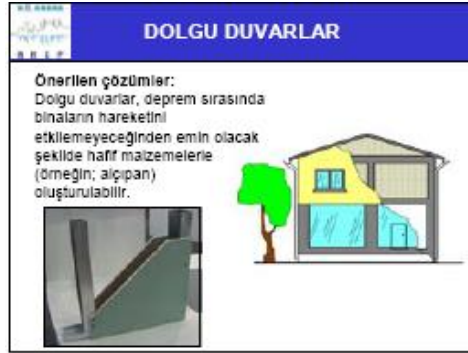
Şekil 1.6: Dolgu duvar uygulaması
