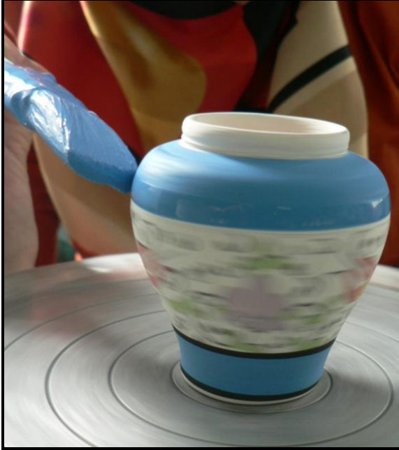
Resim 2. 4: Motifleri boyanmış dik formların turnet üzerinde düz boyama tekniğinde boyanması
