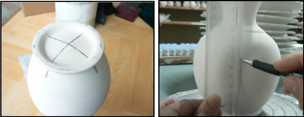
Resim 1. 9: Birimler üzerinde desen basılacak kısımların belirlenmesi
