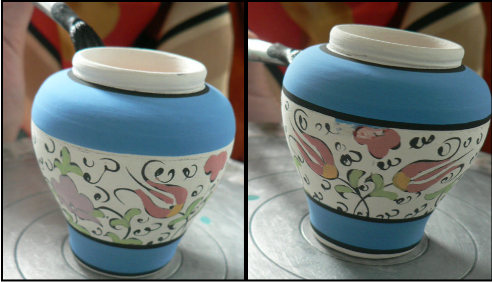
Resim 1. 8: Tahrir ve boya aşamalarından sonra, file çekme işleminin uygulanışı
