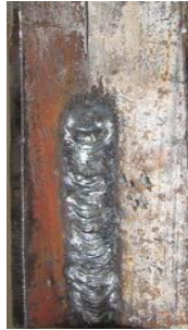
Resim 4.1: Aşağıdan yukarı çekilmiş iç köşe kaynağı
