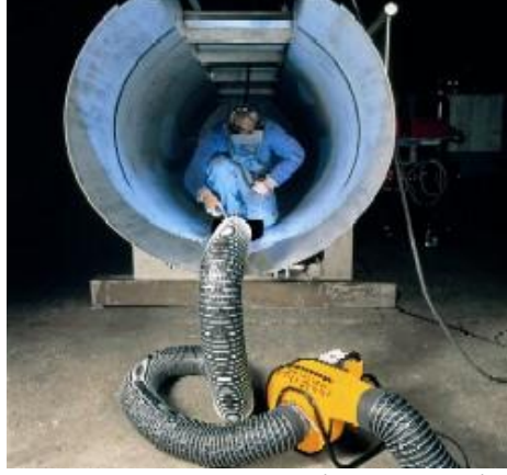
Resim 1.16: Kaynak dumanının, kaynakçıyı etkilemeden emilmesini sağlayan değişik konumlarda konumlandırılan aspiratör
