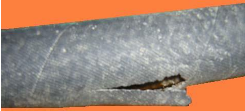
Resim 4.6: Sürtünmeden dolayı dış yüzeyi hasar görmüş hortum
