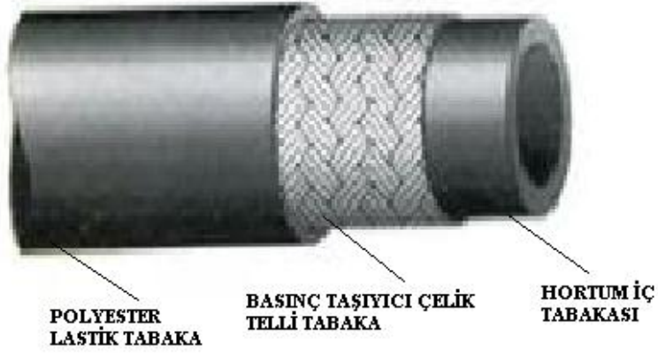
Resim 4.3: Hidrolik hortum kesiti
