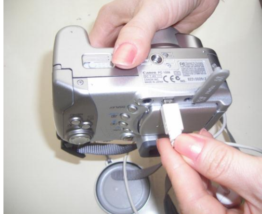
Fotoğraf 3.2: Dijital fotoğraf makinelerinde kablolu aktarım
