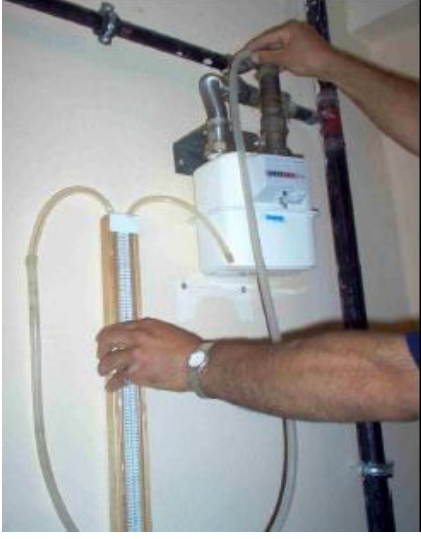
Resim 3.14: Solda Sulu- sađda Civalı -U- manometre
