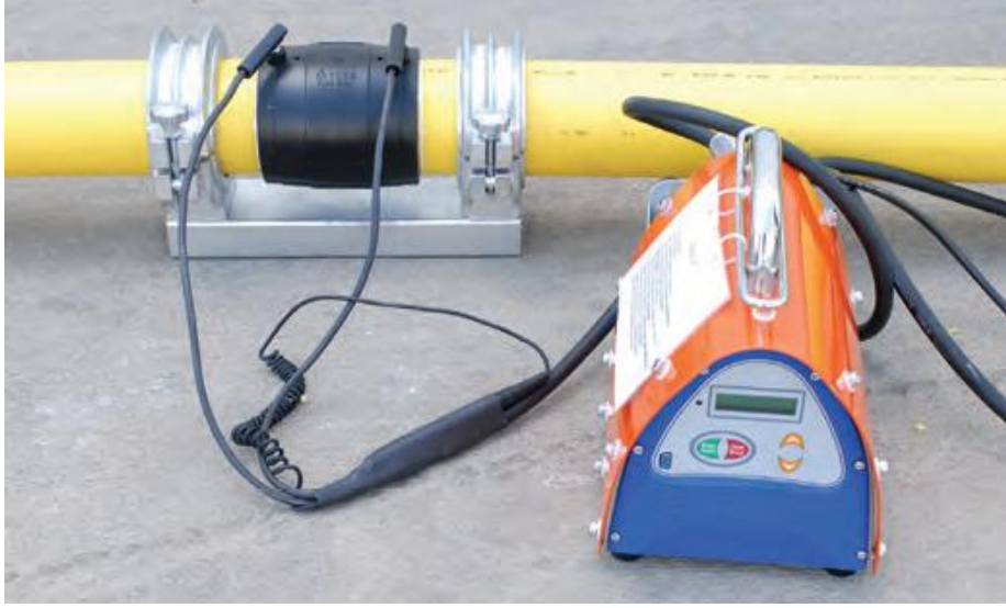
Resim 2.3: Elektrofüzyon kaynak ortamı
