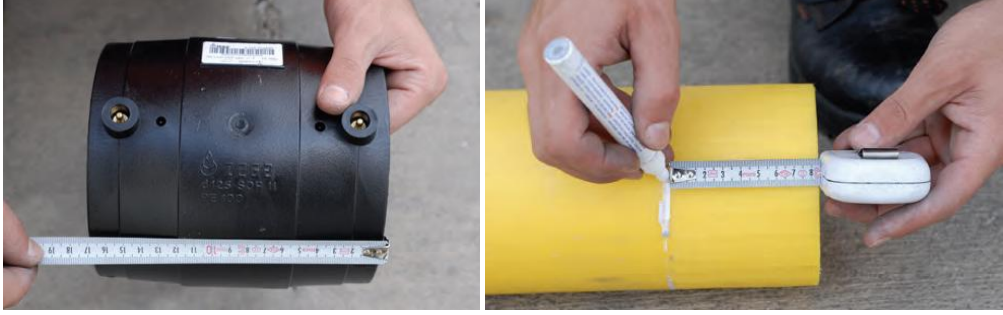
Şekil 2.1: Polietilen boru kazıma mesafe ölçümü
