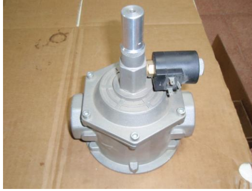
Resim 2.5: Doğalgaz solenoid valfi
