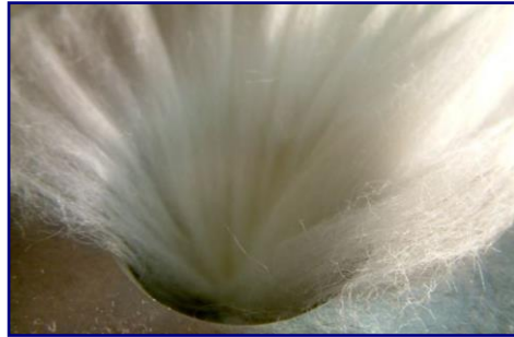
Resim 1.13: Liflerde oluşan elektriklenme
