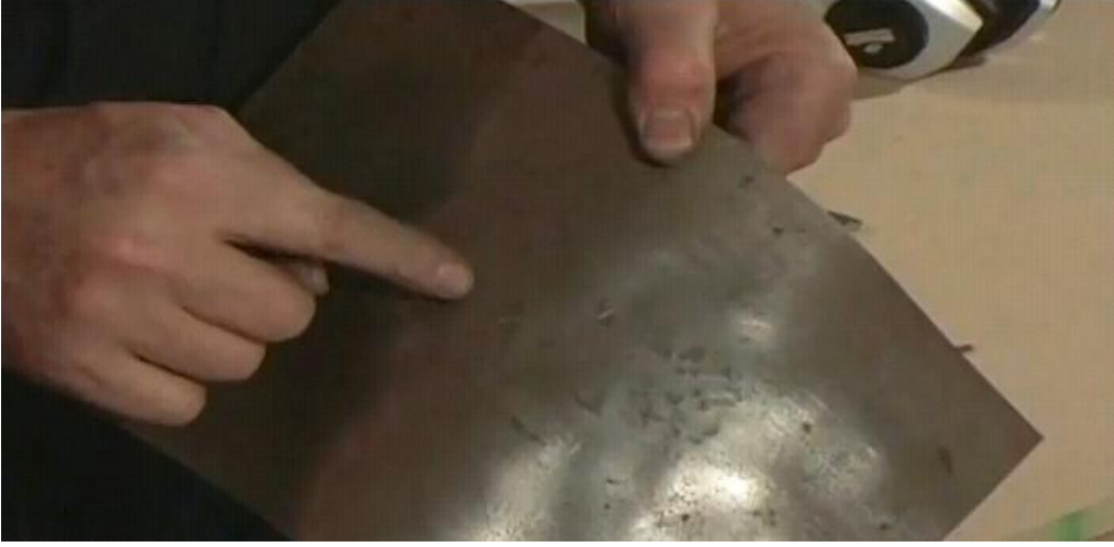
Resim 2.2: Sac ortasında meydana gelen kamburluk
