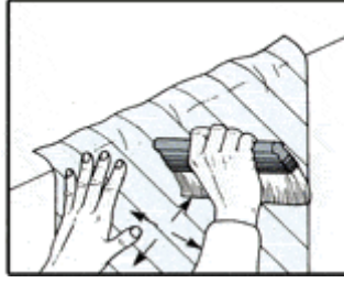
Resim 2.16: Hava kabarcıklarının çıkarılması
